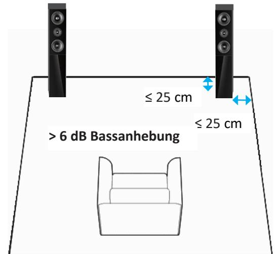
6. Die Entfernung zu den Seitenwänden beeinflusst, neben der Stärke der Basswiedergabe, insbesondere die Ortung von Schallereignissen und damit die Abbildungspräzision. Mit größerem Abstand wird die Ortung genauer, der Klang ausgeglichener. Sehr nahe an den Seitenwänden kommt es zu frühen Reflexionen, die neben einer geringeren Ortbarkeit auch zu einem tendenziell nervösen Klang führen. Vorhänge oder Regale etc. an den Seiten reduzieren diesen Effekt.
